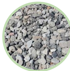
Material drenante y cama de tuberías
